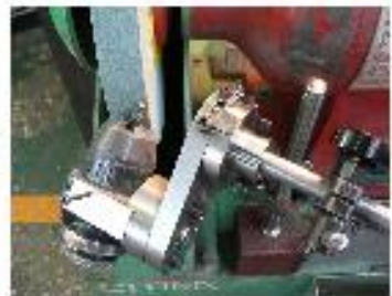
圖10、組立完成的研磨附件
