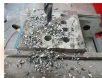
圖24、偏心1.0mm鑽削結果
