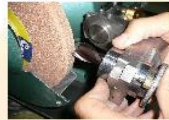
圖35、大端銑刀研磨方式
