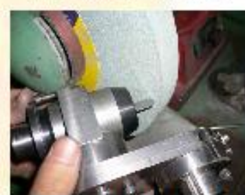
圖18、以假鑽頭設定研磨角度
