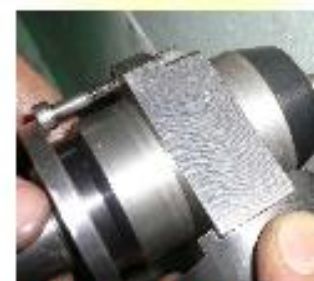
圖17、修正後的夾具
