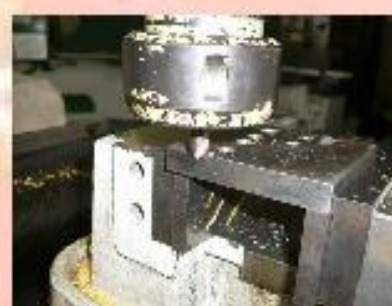
圖29、以銑床對工件邊緣倒角
