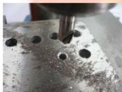
圖28、實際對孔作倒角工作
