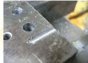
圖33、以端銑刀完成的溝槽加工
