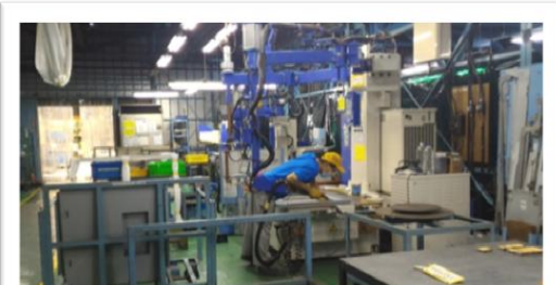
輔助手工點焊設備
