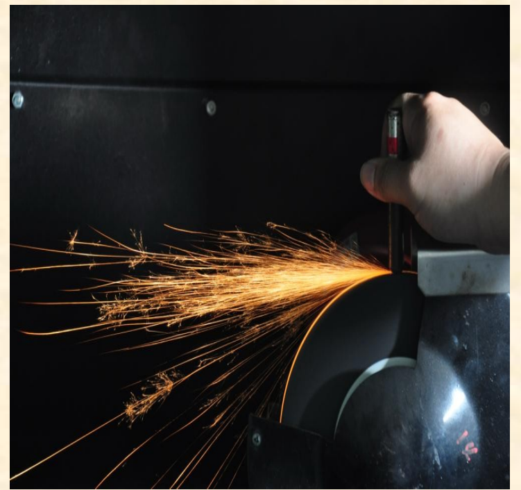
熱處理檢定-材料火花試驗判別
