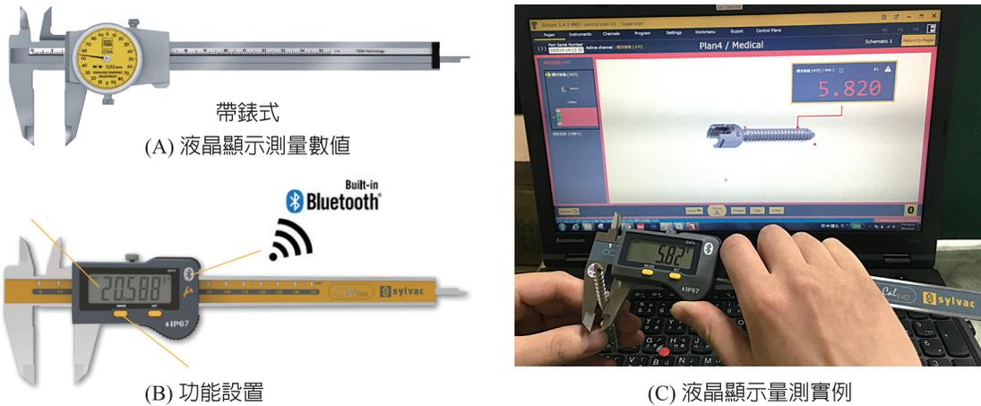
▲ 圖 7-14 帶錶式卡尺與液晶顯示式卡尺 (來源：喬鉅企業 -SYLVAC 提供)
